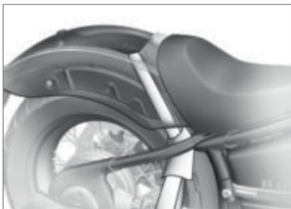
рез качающийся рычаг заднего колеса.
