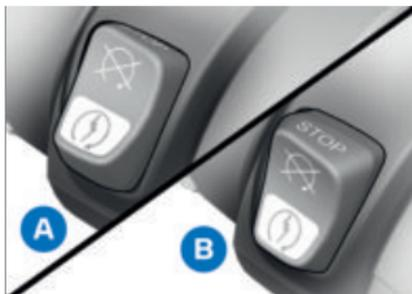
**A** Двигатель выключен
