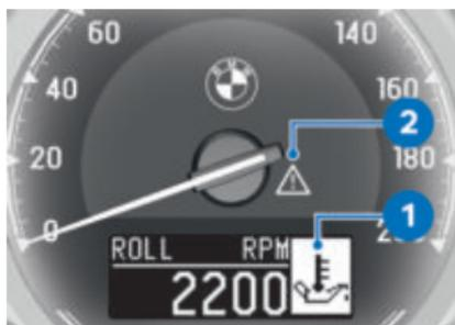
Предупреждения, для которых не предусмотрены отдельные сигнальные лампы, показываются в виде предупреждающего символа **1** на многофункциональном дисплее в сочетании с общей сигнальной лампой **2**. В зависимости от степени важности предупреждения общая сигнальная лампа горит или мигает.
